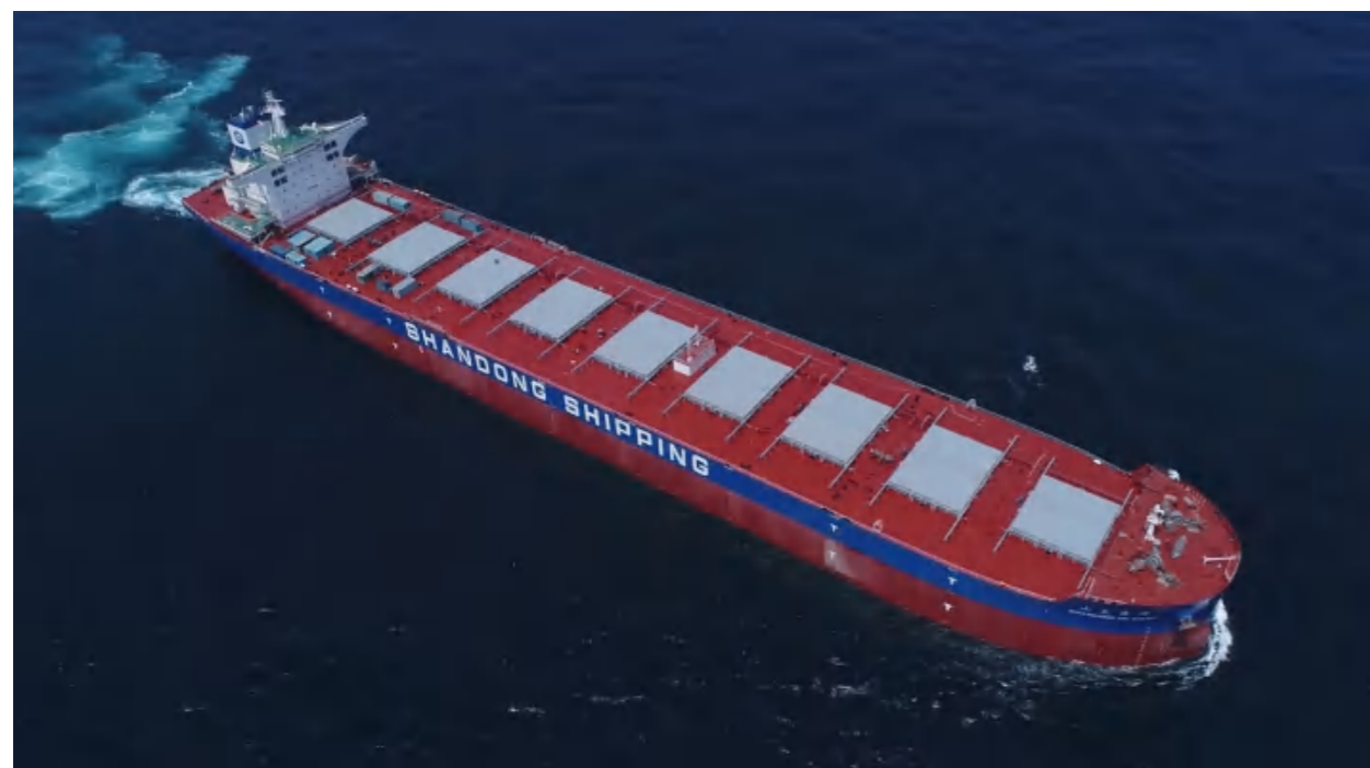
21万吨级甲醇双燃料散货船
