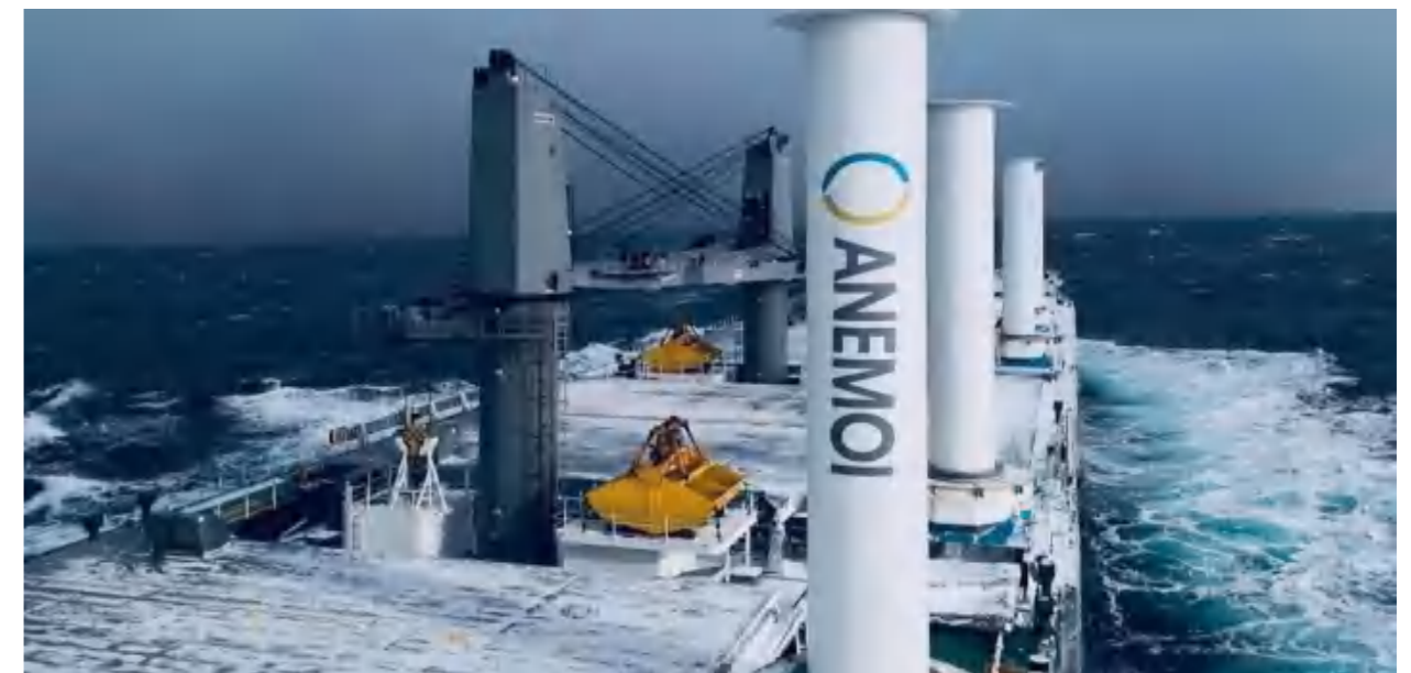
为 ANEMOI 公司配套生产船用风力转子帆
